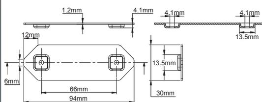
Per il montaggio affiancato della scatola dotata di ventilatore protetta dalle intemperie su un'altra scatola delle stesse dimensioni
