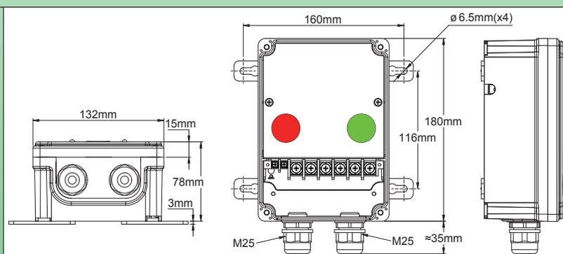
3 × 25A (AC1), 250V, morsettiera con 2 morsetti a vite da 2.5mm<sup>2</sup> e 6 morsetti a vite da 10mm<sup>2</sup>. Spia rossa per l'alimentazione e spia verde in uscita (250V), coperchio trasparente.
