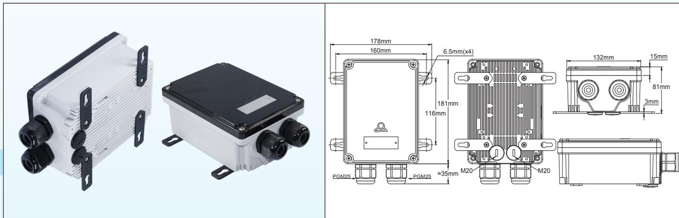
Queste scatole sigillate in alluminio sono verniciate con vernice epossidica RAL 7015. Hanno le stesse dimensioni delle scatole di comando in plastica e utilizzano coperchi piatti. Utilizzano le stesse linguette di montaggio a parete dei modelli in plastica. Sono state progettate per il montaggio di relè a stato solido monofase o trifase il cui raffreddamento è assicurato dalle alette sul lato posteriore.
