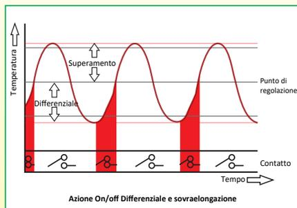
**Differenziale regolabile:** Un differenziale basso è spesso associato alla precisione del controllo. Tuttavia, un differenziale troppo basso provoca cicli brevi di riscaldamento e l'usura prematura dei contatti se si utilizza un relè di potenza, oppure un rapido degrado del compressore se il sistema viene utilizzato per controllare un frigorifero. I regolatori elettronici di questo catalogo hanno un differenziale regolabile per ottimizzare questo funzionamento.
