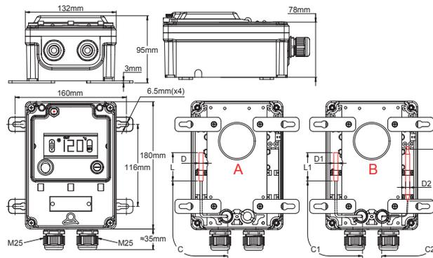
A: Modello a un sensore, solo controllo della temperatura.
